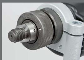
Vòng điều chỉnh để chuyển đổi sang chế độ búa mềm
