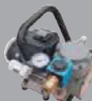
Bơm chân không VP 03 Lưu lượng 25 l/min, Ø khoan max: 150 mm, Áp lực chân không max: 850 mbar
